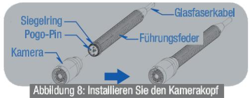
Abbildung 8: Installieren Sie den Kamerakopf
