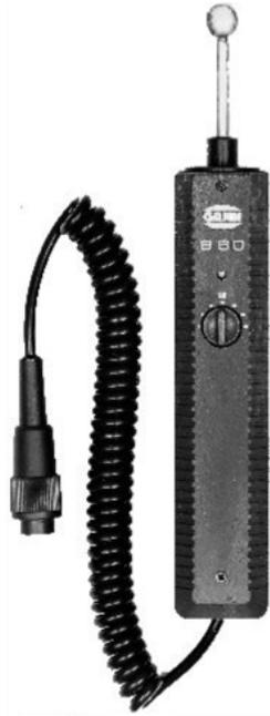
mit integrierter Elektronik zum zerstörungsfreien Aufspüren von Feuchtigkeitskonzentrationen in Bauteilen aller Art sowie zur Erkennung der Feuchtigkeitsverteilung in Fußböden, Wänden und Decken. Die nach einem patentierten Messverfahren arbeitende Elektrode erzeugt ein konzentriertes Hochfrequenzfeld mit großer Tiefenwirkung.
