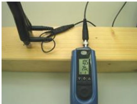
Abbildung 4-3 Messung quer zur Faserrichtung mit M 20
