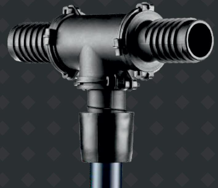
Das gekkufix T-Stück ist in seiner Flexibilität einmalig auf dem Markt. Sie können es mit allen Stutzen verbinden und so z.B. zwei verschiedene Schlauchgrößen miteinander verbinden und einen Estrichadapter oder einen Adapter für die Hohlraumtrocknung befestigen. Die Stutzen werden mit einer halben Umdrehung fixiert.
